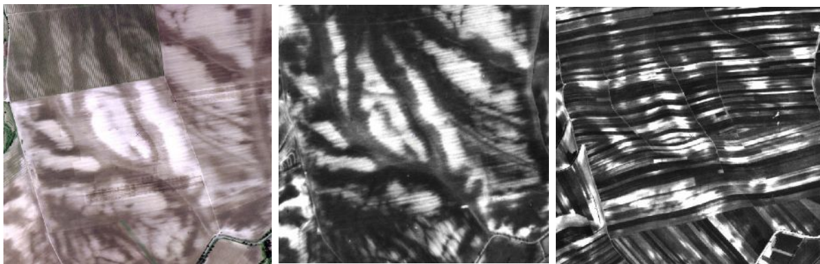
Obr. 1,2,3: Náhled ortorektifikovaných leteckých snímků v různých časových řadách (zleva současnost, 1968 a dole 1938). Erozi postižené plochy (půdotvorná spraš) se jeví podle intenzity jako světlé (bílé) plošky.
