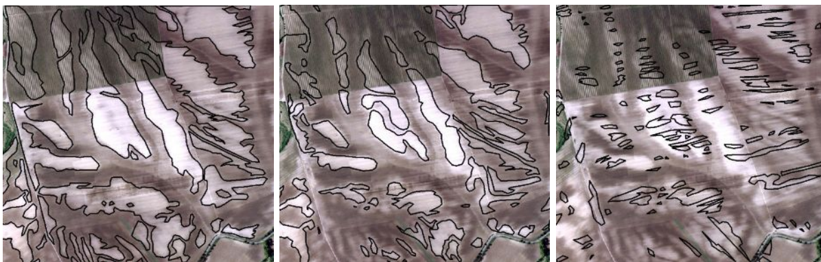
Obr. 4, 5, 6: Výsledek – vektorová vrstva vizuální obrazové interpretace (zleva) za současný stav, rok 1968 a 1938 promítnutý na aktuální ortofotomapu, dokládající vývoj plošné eroze ve sledovaném území.
